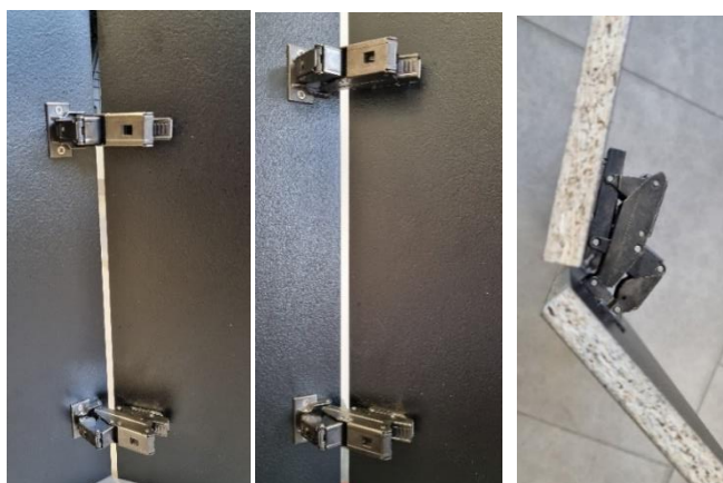
Zdj. 12, 13, 14: Użycie specjalnych zawiasów do cienkiej płyty
