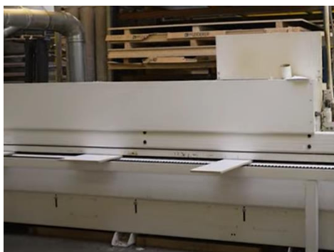
Zdj. 5: Okleiniarka wąskich płaszczyzn
