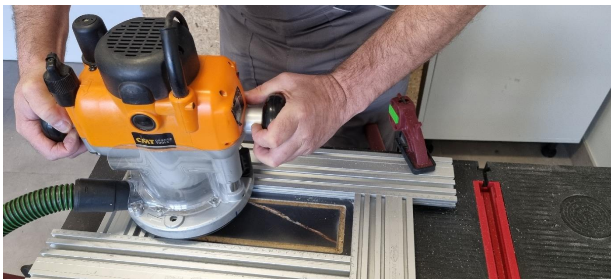
Zdj. 3: Frezowanie otworu przy użyciu frezarki ręcznej oraz szablonu
