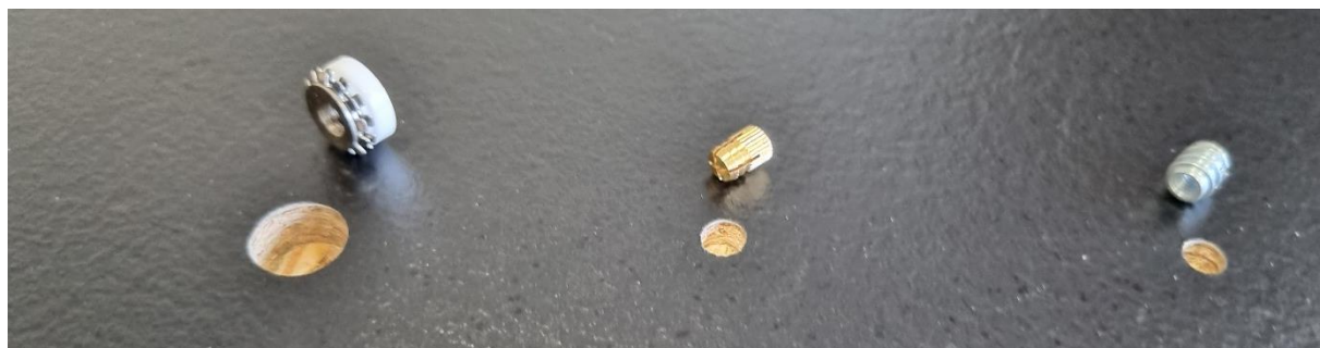
Zdj. 8: Wywiercone otwory pod mufy
